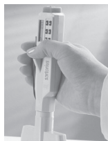
挤压吸头退除杆，退除吸头
