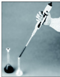
Fig. 7: Distribution du liquide
